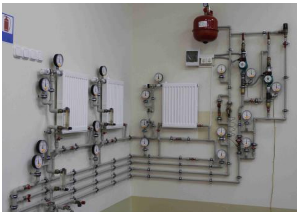
Стенд "Балансировка современных систем отопления"
