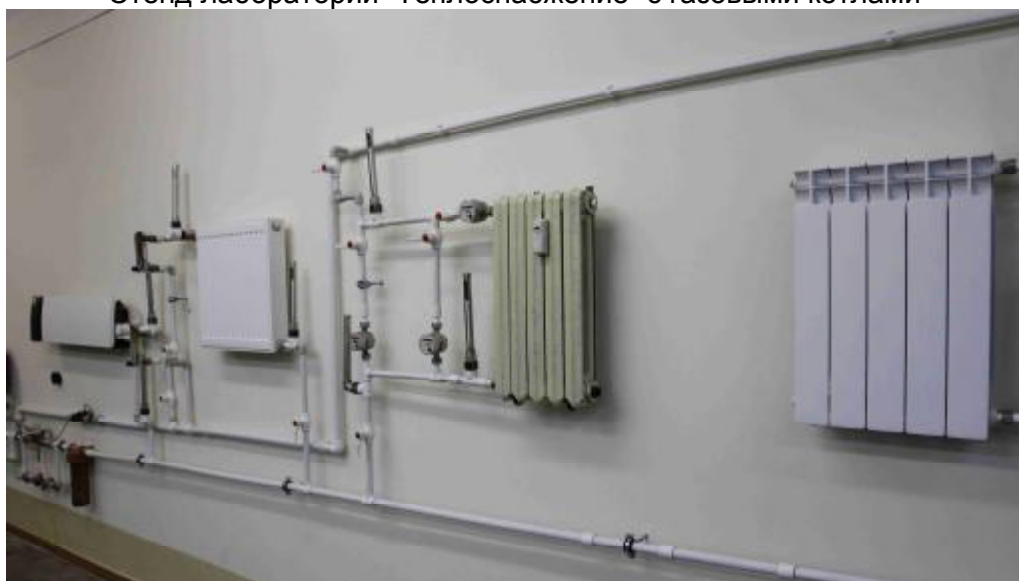
Стенд “Система отопления” с различными отопительными приборами
