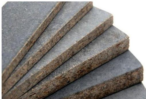
**Рисунок 1 – Цементно-стружечные плиты**
