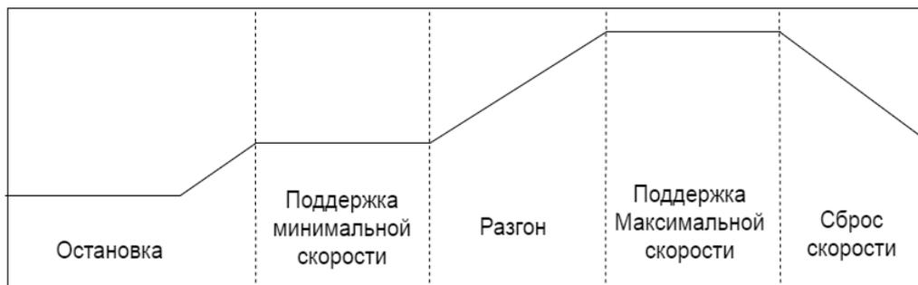
**Рисунок 1 – Состояния работы электрокара “Инфобус”**
