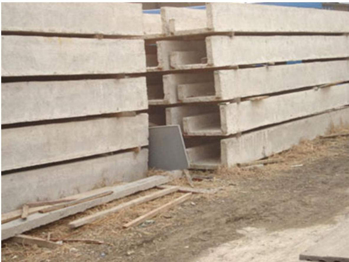
**Рисунок 9 – Конструкции лотков**
