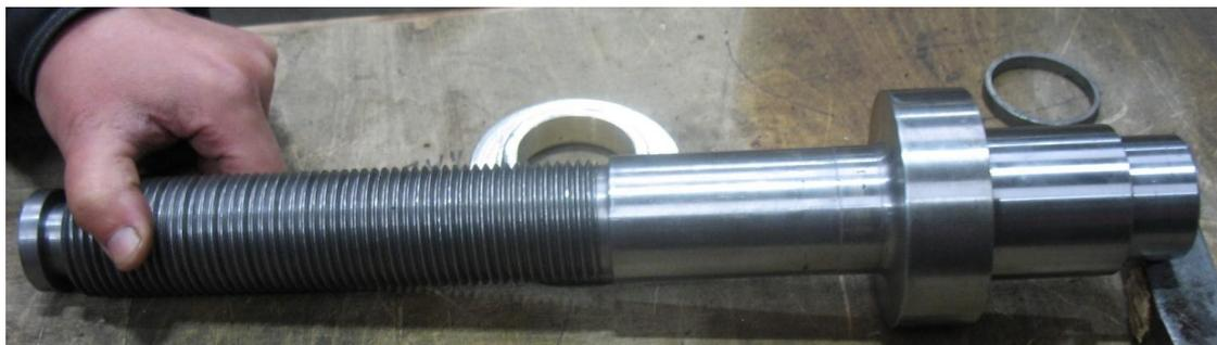
**Рисунок 1 – Вал гидроцилиндра**
