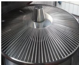
**Рисунок 1 – Лучевой ротор для обработки С. с/п**
