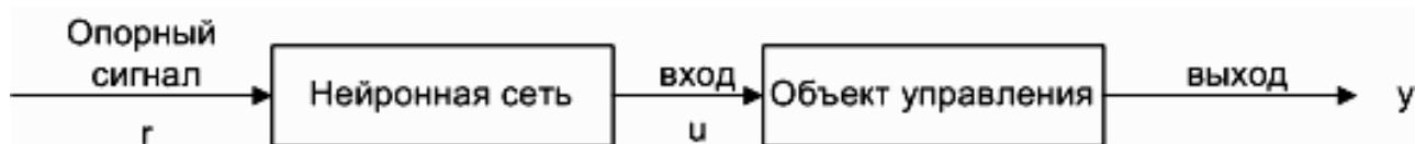
Рисунок 1 – Последовательная схема нейронного управления
