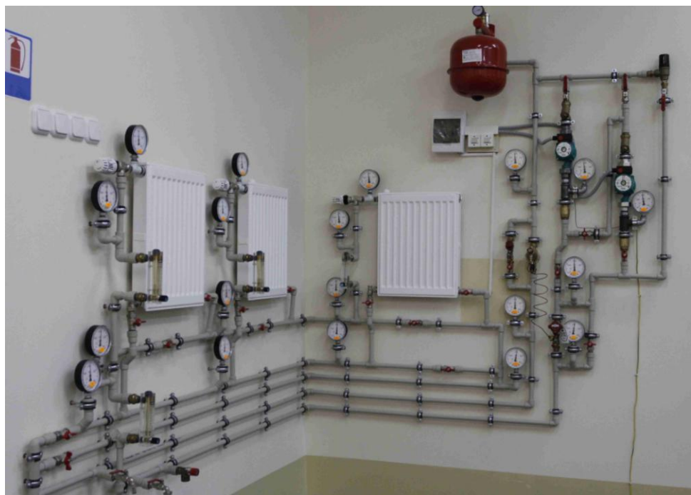
Стенд "Балансировка современных систем отопления"
