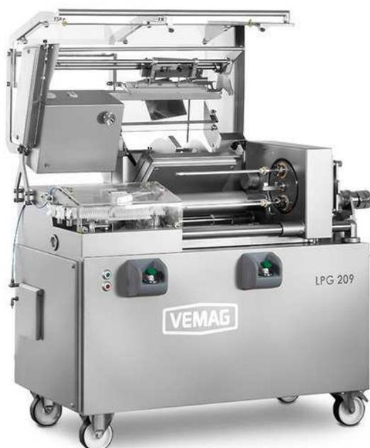
Для формования массовых сосисок широкое распространение получили сосисочные автоматы компании «Vemag» (Германия) (рисунок 3). Возможная длина сосиски в этом автомате находится в диапазоне от 20–400 мм. Возможный диаметр оболочки составляет 15 – 34 мм [4].
