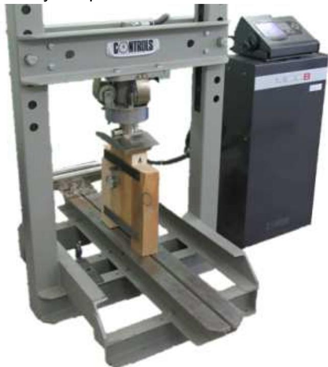
Сжимающее усилие от машины к образцу передавалось через распределительную стальную пластину. Образцы испытывались с непрерывно возрастающей нагрузкой со скоростью 70 Н/сек до полного разрушения соединений по методике [5]. На рисунке 1 приведён общий вид испытания нагельных соединений. После разгрузки проводился осмотр и фотографирование разрушенных образцов (рисунок 2).
