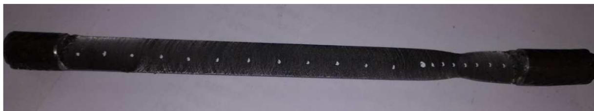
**Рисунок 6 – Образец для определения твердости**
