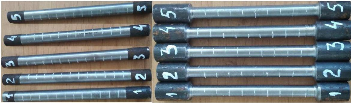
**Рисунок 1 – Образцы для испытаний диаметром 13 мм и 10 мм**
