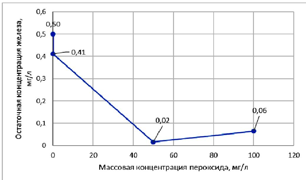
**Рисунок 5 – Влияние массовой концентрации пероксида водорода на очистку воды от железоорганических соединений**
