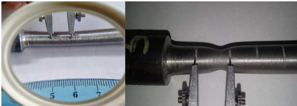
**Рисунок 2 – Определение деформации на малой базе**
