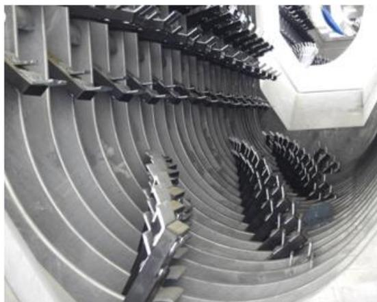
**Рисунок 3 – Скребмашина непрерывного действия FRONTMATEC**
