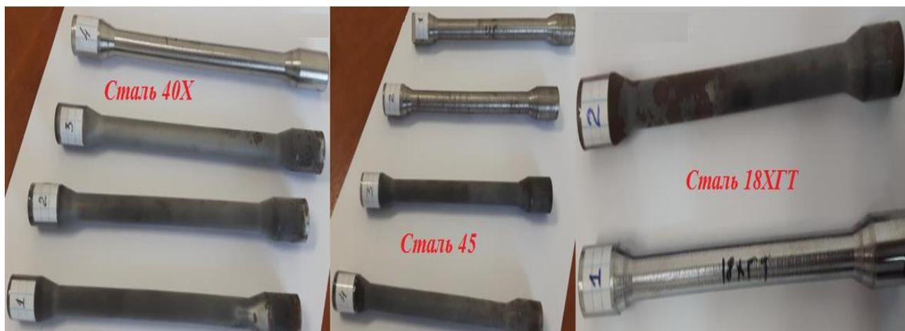
**Рисунок 1 – Образцы для испытаний, изготовленные из соответствующих марок сталей и подвергнутых ИПА**
