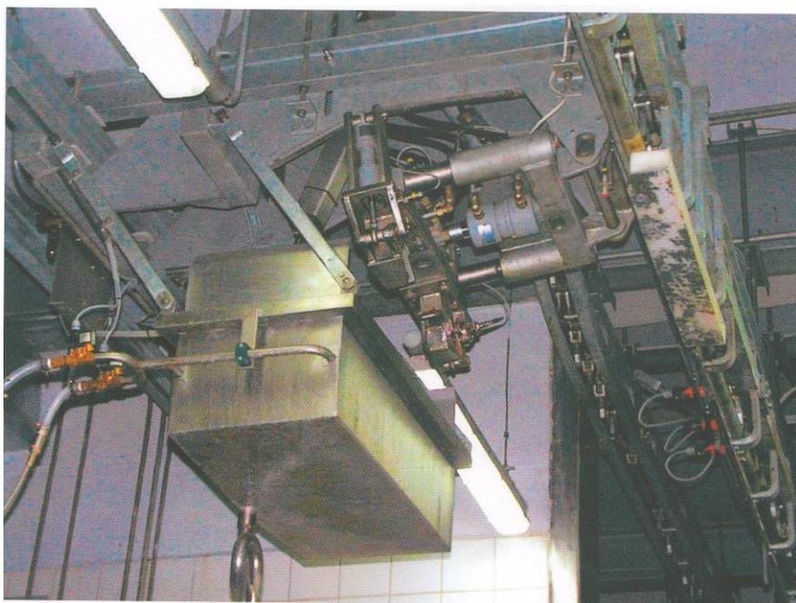
**Рисунок 2 – Устройство фиксации задних ног при снятии шкуры фирмы Bvss**
