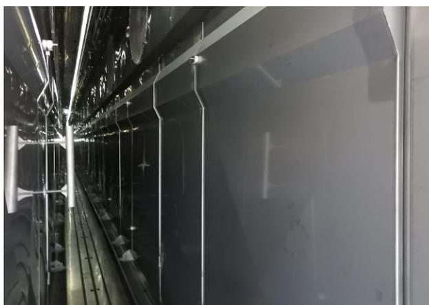
**Рисунок 2 – Шпарчан туннельного типа Frontmatec (Дания)**
