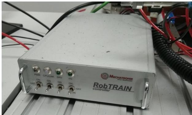
**Рисунок 2 – Контроллер робота-манипулятора RobTRAIN2**
