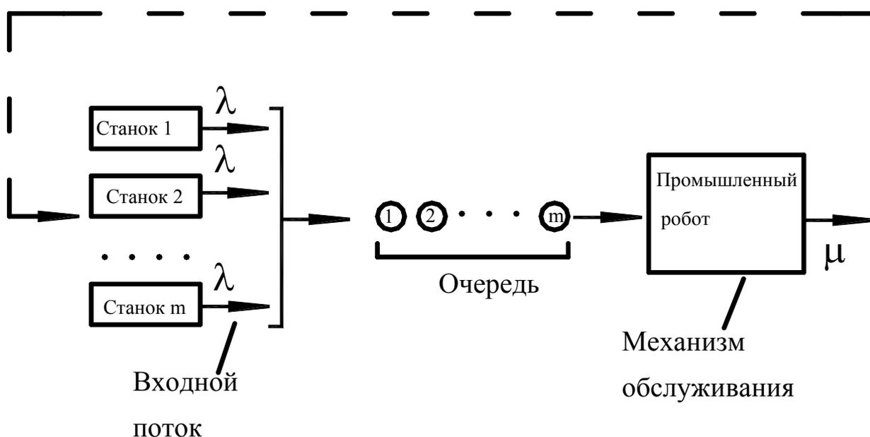
Рис. 1. Схема замкнутой одноканальной СМО
