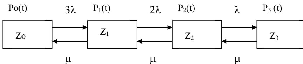
Рис 3. Пример графа состояний СМО, моделирующей ГПС из трех станков и одного промышленного робота
