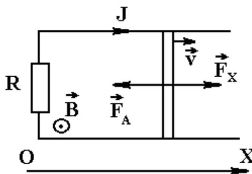
Чтобы провод перемещался по стержням равномерно, к нему должна быть приложена внешняя сила  $\vec{F}$ , составляющая  $\vec{F}_X$  которой равна по модулю силе Ампера  $\vec{F}_A$  и направлена в противоположную сторону (см. рисунок), т.е.
