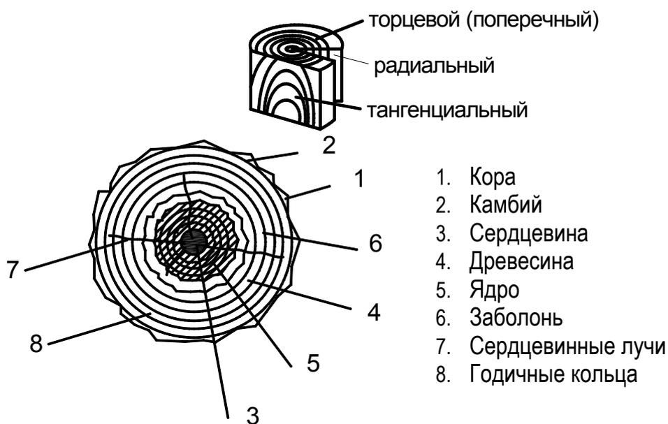
Рисунок 2.1 – Макроструктура древесины
